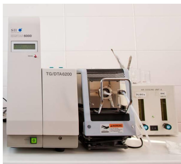
Obrázek 29: Termický analyzátor Exstar TG/DTA 6200 (Seiko Instruments Inc.) pro provedení termogravimetrie a diferenční termické analýzy do teploty 1100 °C.
