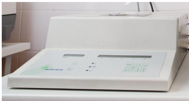
Obrázek 39: Termický analyzátor Termosystem DSC12E pro heat flux diferenční skenovací kalorimetrii
