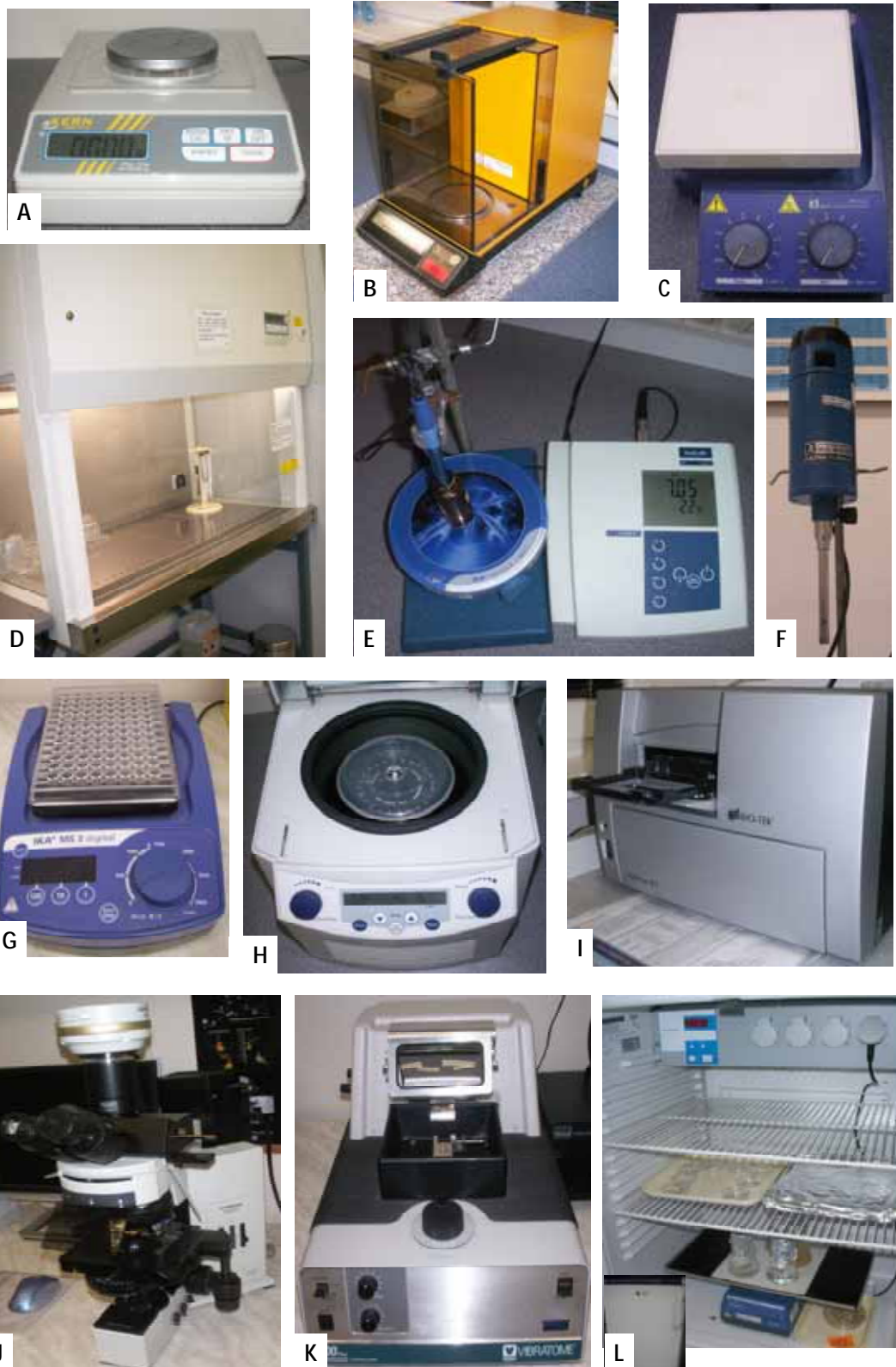
Obr. 19 Přístroje. Digitální předvážky (A), analytické váhy (B), elektromagnetická míchačka (C), flow-box (D), pH metr (E), homogenizátor (F), mikrodestičková třpačka (G), chlazená centrifuga (H), mikrodestičkový spektrofotometr (I), světelný a fluorescenční mikroskop Olympus BX50 s digitální kamerou (J), vibrátorem (K), termostatická skříň (L).
