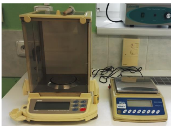
Obr. 1: Váhy v biochemické laboratoři. A – analytické váhy; B – předvážky.
