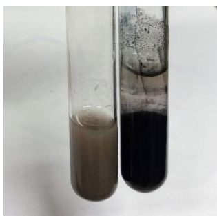
Obr. 5: Kontrolní reakce dusičnanu stříbrného (vlevo) a sraženina redukovaného stříbra vitamínem C (vpravo).
