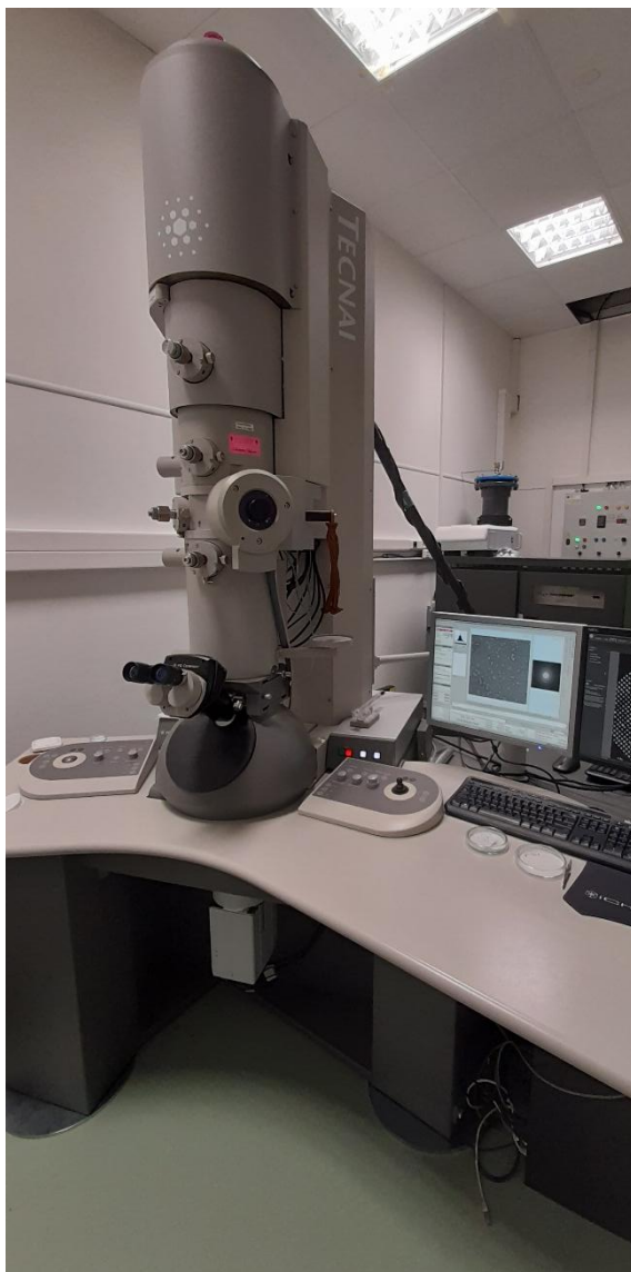
Obr. 1. Transmisní elektronový mikroskop a jeho klíčové komponenty. Snímek transmisního elektronové mikroskopu Tecnai G2 F20 (FEI) v laboratoři elektronové mikroskopie Katedry biofyziky PŘF UP (vlevo). Schematický řez elektronovým mikroskopem zobrazující jeho klíčové komponenty (vpravo).
