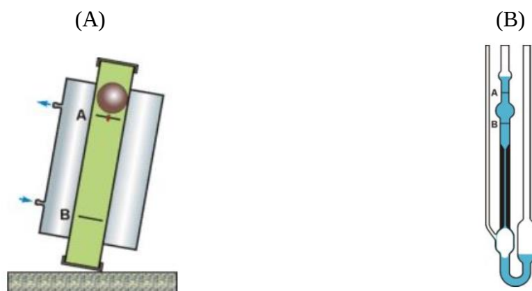
Obrázek 7. Höpplerův viskozimetr (A) a Ostwaldův viskozimetr (B), převzato z webu [72].
