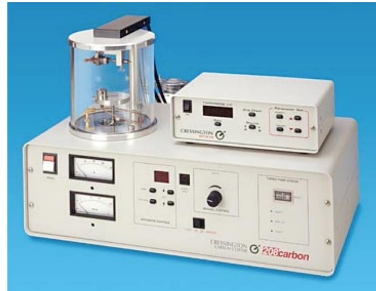
napařování uhlíku ve vakuované komoře
